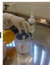
Armazenando dentro pote para evitar vazamento
